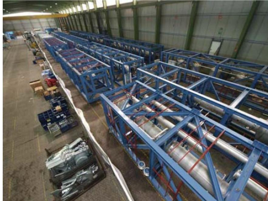
Установка состоит из модулей в габаритах стандартных морских контейнеров, перерабатывает поток выходящих газов, соответствующих тепловой мощности 5МВт. (Sandhya Eswaran, Song Wu, Robert Nicolo, Hitachi Power Systems America, Ltd., COAL-GEN 2010)
