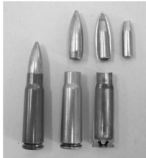
Рис. 1 Загальний вид унітарних патронів та особливості конструкції елементів спорядження
