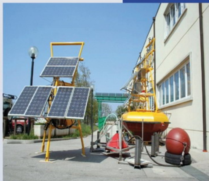
Малюнок 2 Буй для моніторингу з сонячними батареями для постачання енергії, пліт і пристрій для збирання зразків газу з дна моря.
