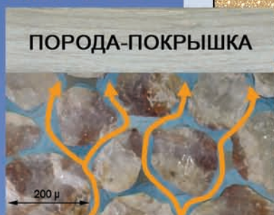
Рисунок 1 Закачанный CO 2 , который легче воды, как правило поднимается и останавливается перекрывающими непроницаемыми породами.
