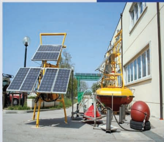
Рисунок 2 Буй для мониторинга энергоснабжающими солнечными батареями, плот и устройство для взятия образцов газа со дна моря.
